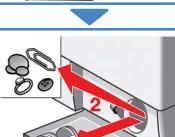
داخل درپوش و محفظه پمپ را از پرز و اشیاء دیگر تمیز کنید (پروانه پمپ باید به راحتی بچرخد)
