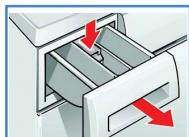
جا پودری را بیرون کشیده و با فشار دادن مغذی آن به پایین، جا پودری را بطور کامل از ماشین جدا کنید.
