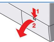
دریچه تاشوی قسمت سرویس را باز نموده و آن را از بدنه دستگاه جدا کنید.
