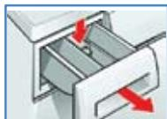
جا پودری را بیرون کشیده و با فشار دادن مغذی آن به پایین، جا پودری را بطور کامل از ماشین جدا کنید.
