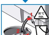
دریچه تعمیرات باز نموده و آن را از بدنه دستگاه جدا کنید.
